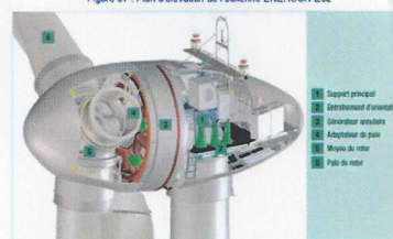
Figure 98 : Schéma de l'intérieur d'une nacelle ENERCON
